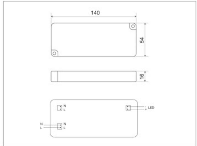
Stromversorger IP45 Höhe 16 mm mit Gleichstrom, Einbaugerät.
