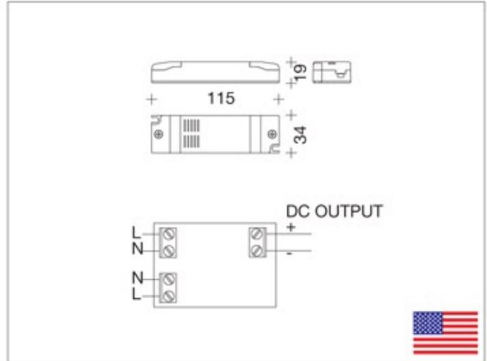
Unabhängiger Stromversorger 10W mit konstantem Gleichstrom.
