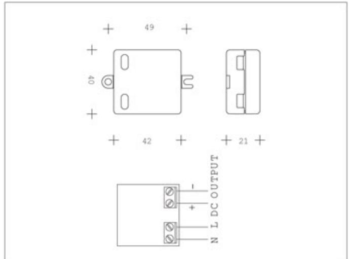
Stromversorger 3W mit konstanter Spannung, Einbaugerät.
